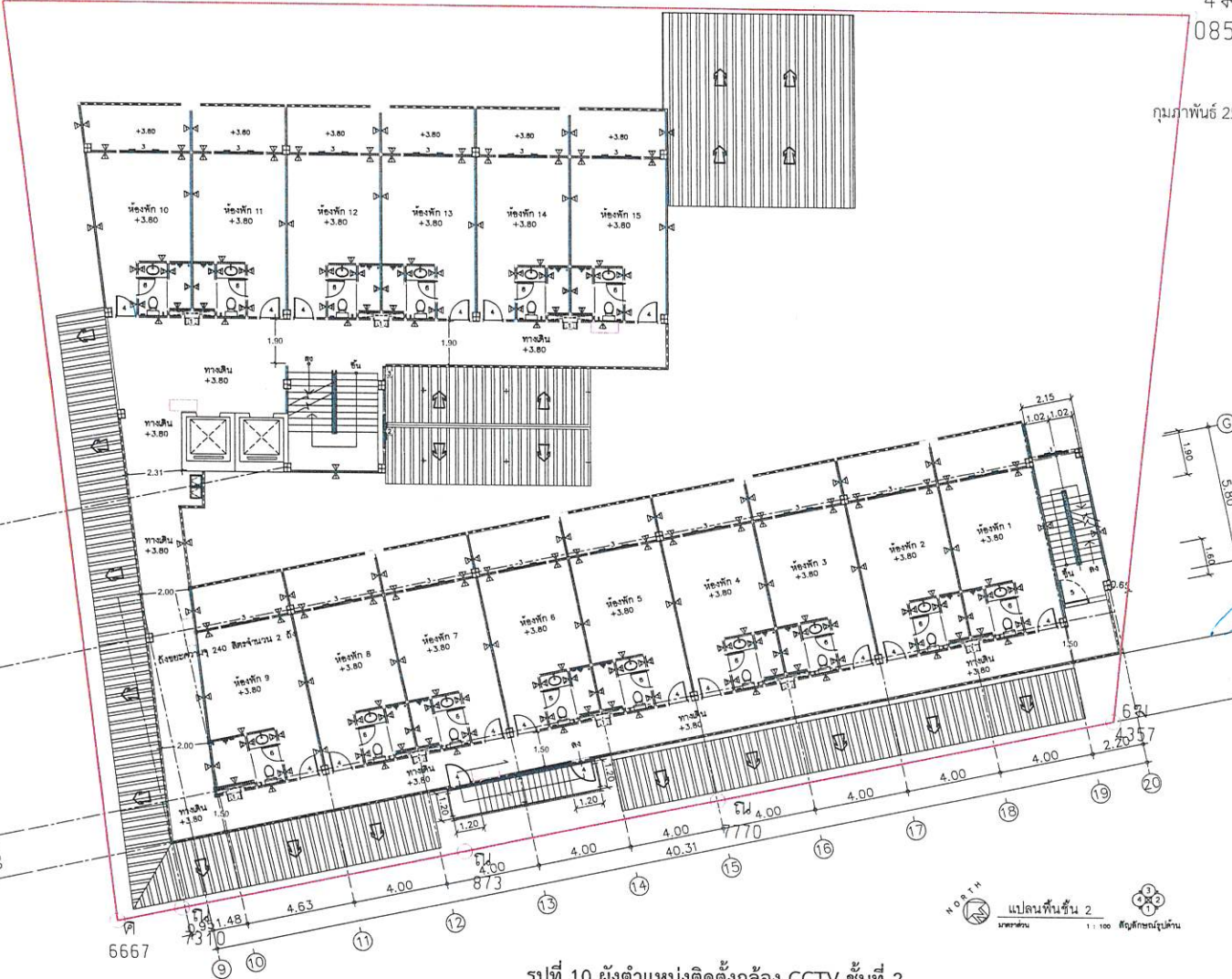
รูปที่ 10 ผังตำแหน่งติดตั้งกล้อง CCTV ชั้นที่ 2
